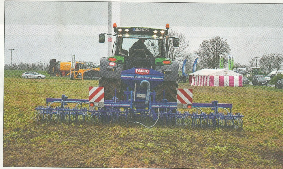
Les compartiments de dents du Grasmaster s'adaptent de façon optimale aux reliefs du terrain.
