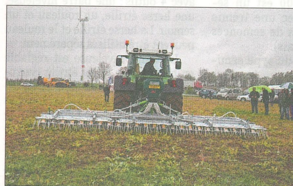
Le modèle R6S5 du Scariflex remplace la rangée de palettes étroites du R5S par un 5 e rang de dents flexibles.
